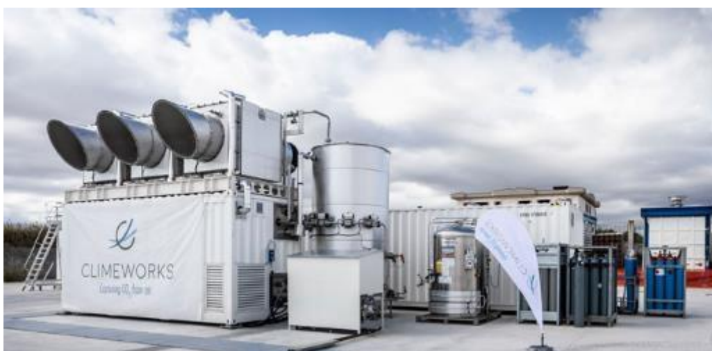
图 6：Climeworks 的直接由空气捕捉 CO 2 （DAC）设备
